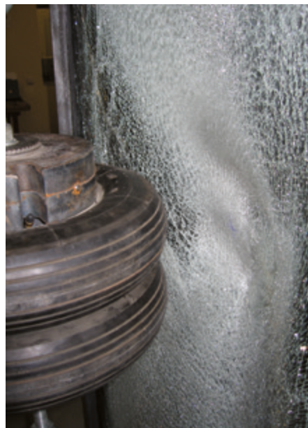
Nach normgemäßem Nachpendeln aus 100 mm Höhe
